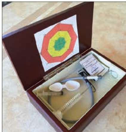
Die Elektronische Zunge erlaubt eine objektive Messung des elektrochemischen Fingerprints eines Lebensmittels.
