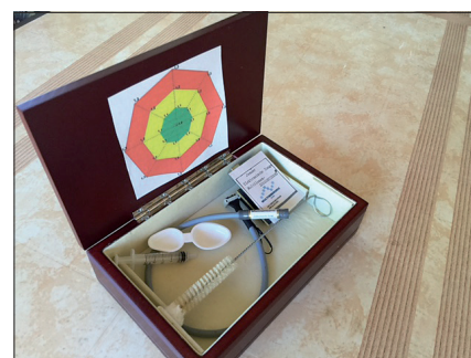
Figura 1: Equipamiento para la lengua electrónica Multiionen-SENSORICCARD® de Jena compuesto por un sistema electrónico y un cabezal de medición, que se conectan a una computadora mediante un cable USB, y un cepillo de limpieza, una cuchara medidora y una jeringa sin aguja para toma de muestras.
